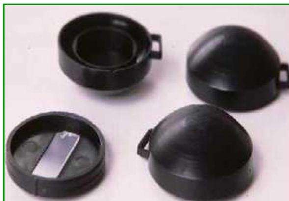
*Foto 1.* Rivelatori di radon di tipo passivo.
