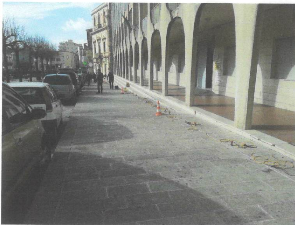
Foto 3: Stesa sismica a rifrazione
