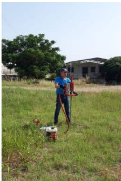
Foto 41 - Prova penetrometrica (P8) eseguita in C.da Spinasanta
