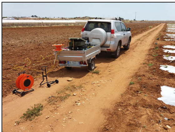
Foto c-d: Fase di esecuzione ERT T1 (località Timperosse) – ERT T2 (località Spinazza).
