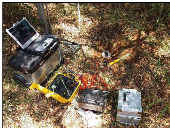
Fase di esecuzione HVSR N3 (a sinistra) e HVSR N4 (a destra)
