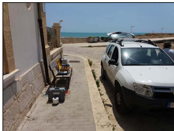
Fase di esecuzione HVSR N7 (a sinistra) e HVSR N5 (a destra)
