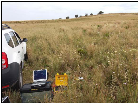
Fase di esecuzione HVSR N9 (a sinistra) e HVSR N8 (a destra)
