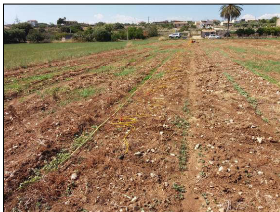
Foto a-b: Fase di esecuzione ERT T6 (località Gurgazzi) – ERT T4 (località Fumarie).
