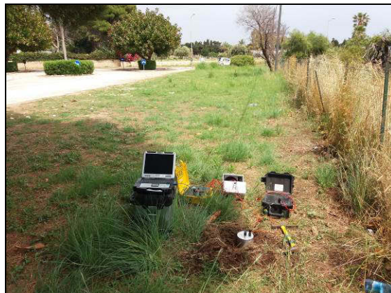
Fase di esecuzione HVSR N9 (a sinistra) e HVSR N8 (a destra)
