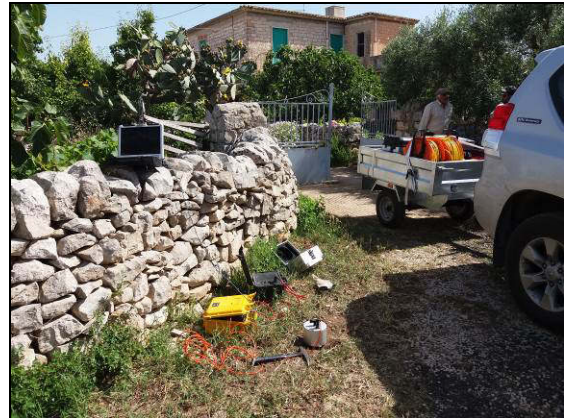
Fase di esecuzione HVSR N1 (a sinistra) e HVSR N2 (a destra)
