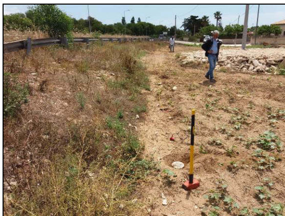
Foto e: Fase di esecuzione MASW M8
