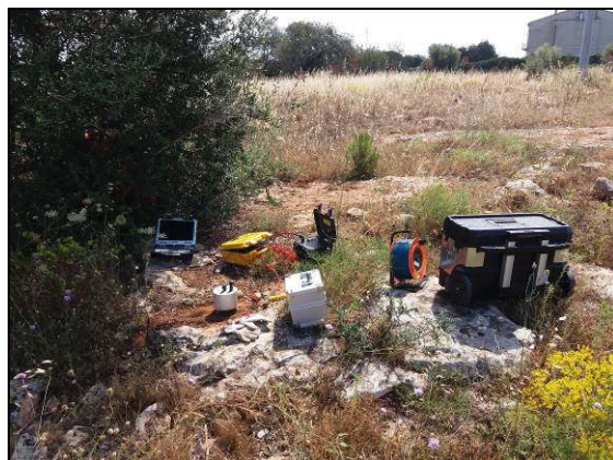
Fase di esecuzione HVSR N3 (a sinistra) e HVSR N4 (a destra)
