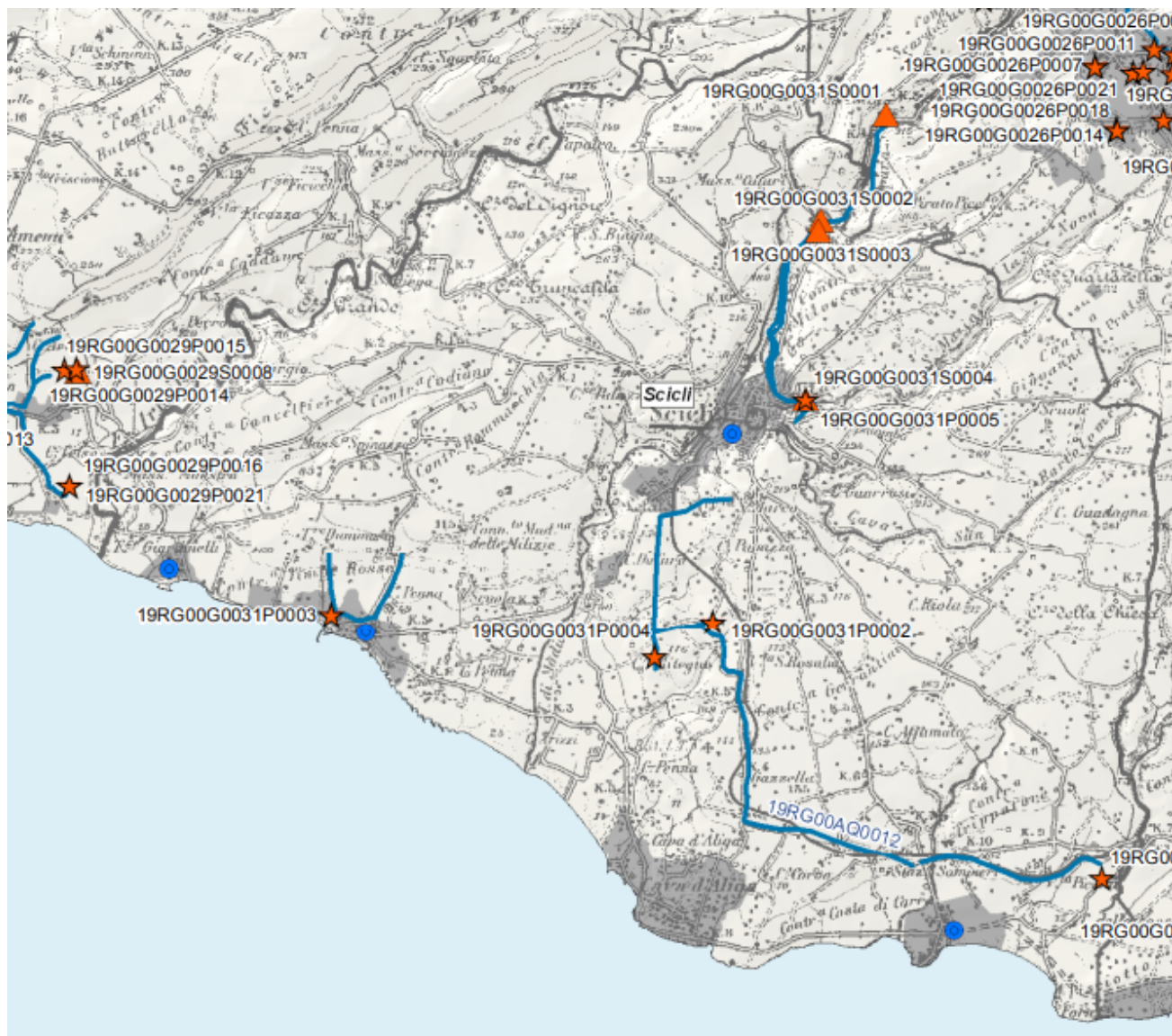
Fig - Planimetria della rete idrica PRGA 2023 . Con la stellina è indicato il pozzo, con il triangolo la sorgente, in blu l'acquedotto.
