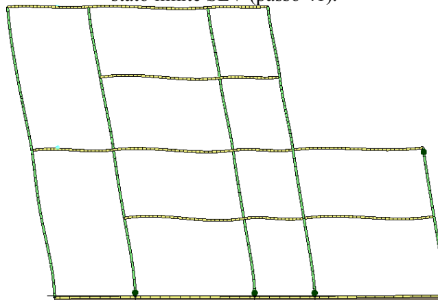
Analisi "Pushover -Y Massa". Configurazione della parete 30 in corrispondenza della capacità relativa allo stato limite SLV (passo 41).
