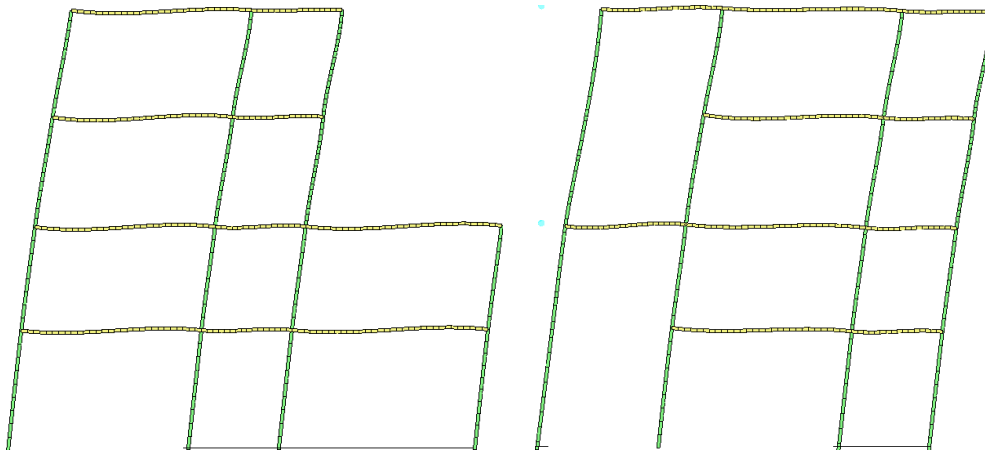
Analisi "Pushover +Y Acc". Configurazione delle pareti 34 e 36 in corrispondenza della capacità relativa allo stato limite SLV.
