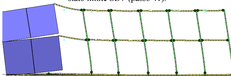
Analisi "Pushover -Y Massa". Configurazione della parete 9 in corrispondenza della capacità relativa allo stato limite SLV (passo 41).
