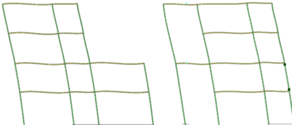
Analisi "Pushover -Y Acc". Configurazione delle pareti 34 e 36 in corrispondenza della capacità relativa allo stato limite SLV.
