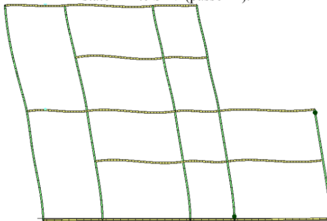
Analisi "Pushover -Y Acc". Configurazione della parete 30 in corrispondenza della capacità relativa allo stato limite SLV (passo 24).
