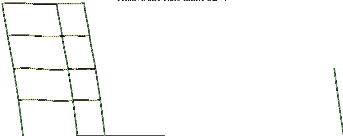
Analisi "Pushover -Y Massa". Configurazione della parete 28 in corrispondenza della capacità relativa allo stato limite SLV (passo 41).
