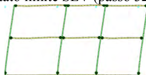
Analisi "Pushover +X Massa". Configurazione della parete 13 in corrispondenza della capacità relativa allo stato limite SLV (passo 32).
