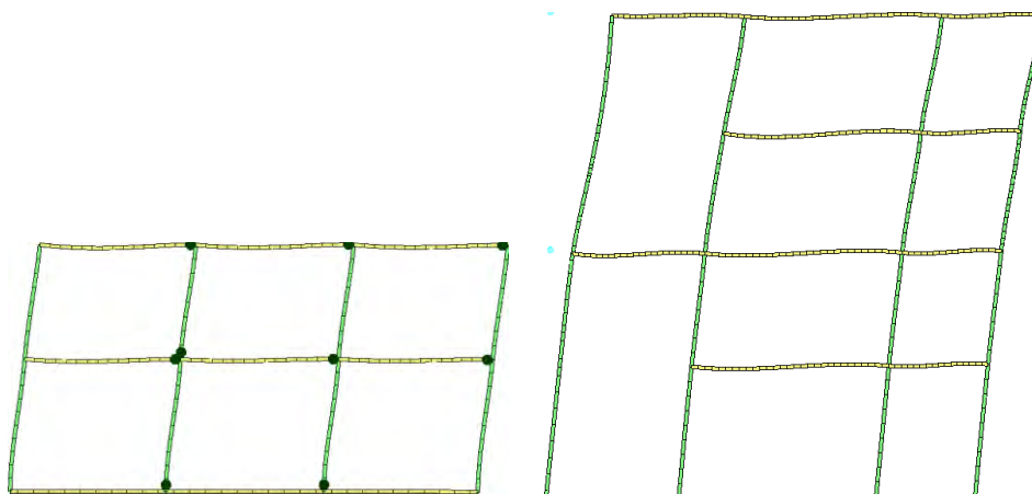
Analisi "Pushover +Y Acc". Configurazione delle pareti 6 e 26 in corrispondenza della capacità relativa allo stato limite SLV.
