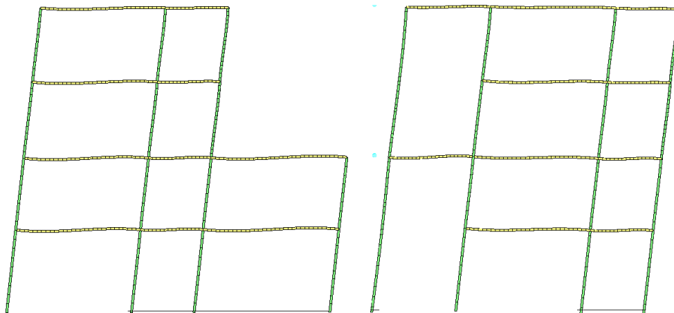
Analisi "Pushover +Y Massa". Configurazione delle pareti 34 e 36 in corrispondenza della capacità relativa allo stato limite SLV.
