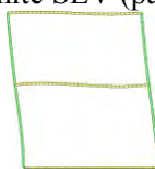
Analisi "Pushover -X Massa". Configurazione della parete 14 in corrispondenza della capacità relativa allo stato limite SLV (passo 29).
