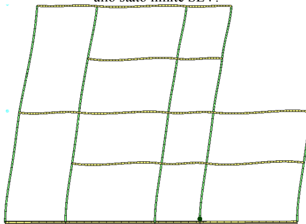
Analisi "Pushover +Y Acc". Configurazione della parete 35 in corrispondenza della capacità relativa allo stato limite SLV (passo 22).
