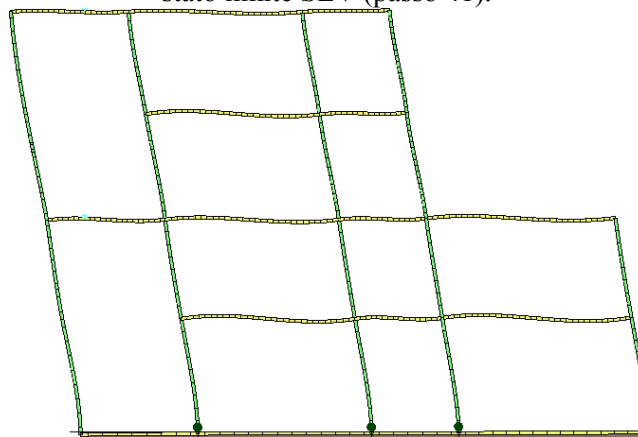
Analisi "Pushover -Y Massa". Configurazione della parete 32 in corrispondenza della capacità relativa allo stato limite SLV (passo 41).
