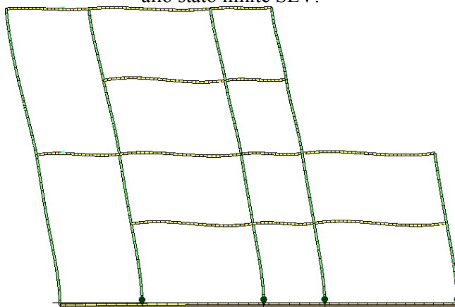
Analisi "Pushover -Y Acc". Configurazione della parete 35 in corrispondenza della capacità relativa allo stato limite SLV (passo 24).
