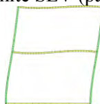
Analisi "Pushover +X Massa". Configurazione della parete 14 in corrispondenza della capacità relativa allo stato limite SLV (passo 32).
