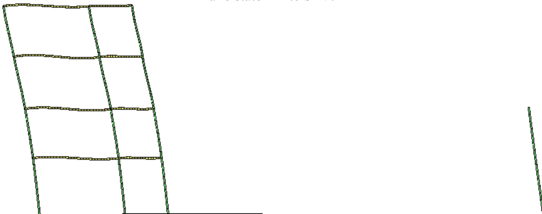
Analisi "Pushover -Y Acc". Configurazione della parete 28 in corrispondenza della capacità relativa allo stato limite SLV (passo 24).
