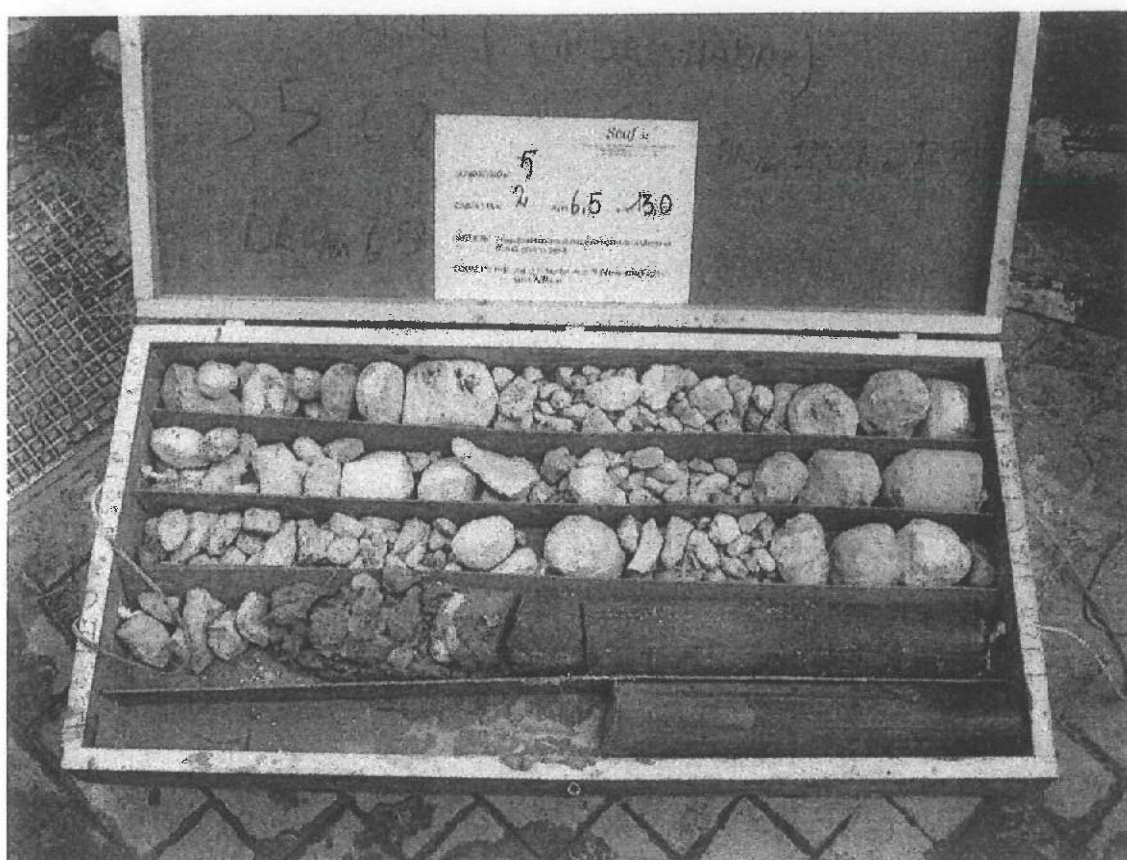
Foto 12: sondaggio 5, cassetta portacampioni 2.
